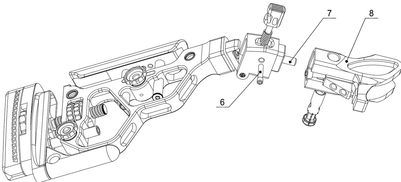
**Шаг 4:** Установить переходник на ствольную коробку и затянуть винт М6х40 поз. 9 усилием 7-8 Нм.
