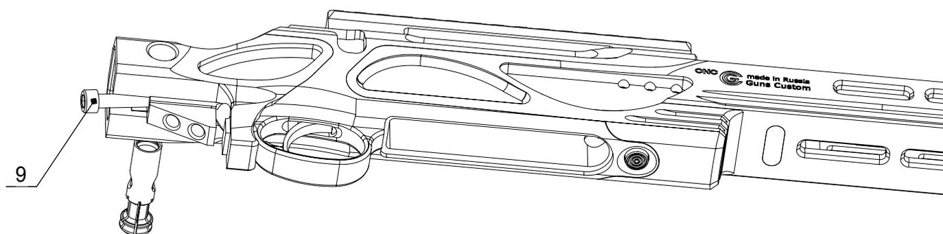
**Шаг 5:** Установить приклад и затянуть винтом М8 поз.7 с усилием до 10Нм.
