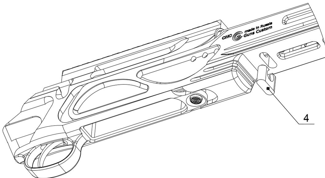
**Шаг 6:** В отверстие переднего торца цевья вставить ключ удлинитель поз. 5 шестигранником 5 мм в сторону винта поз.1. Придерживая закладную вставку, попасть шестигранником в шляпку винта поз.1 (возможно потребуются фонарик и терпение). Вращением винта поз.1 продвинуть цевье до упора.
